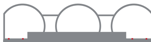
пилонная станция глубокого заложения
